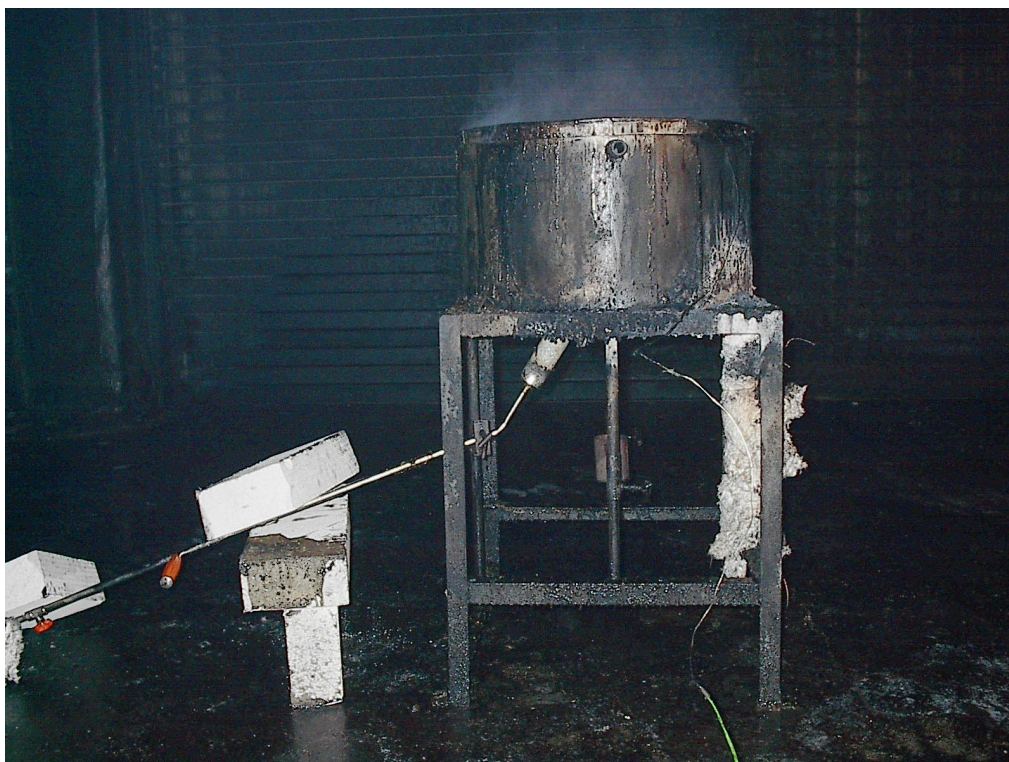
Foto 2.1: Fotografi som viser karet med stativ og brenner.
